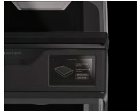
Cuando llegue el momento de sustituir los filtros, Clean Air le avisará a través de la pantalla táctil de su impresora 3D METHOD. Saque fácilmente el filtro viejo y deslice uno nuevo, sin necesidad de herramientas.
